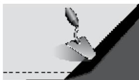
На место формирования торцевого нахлеста нанести слой битумной мастики. Место склейки дополнительно прокатать роликом. Ширина торцевого нахлеста составляет 150 мм.
