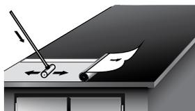
С одной стороны рулона вытянуть адгезионную пленку и одновременно прижать материал к основанию. После приклейки материал прикатывают валиком или щеткой.
