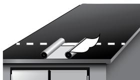
Материал укладывается параллельно карнизному свесу. Укладку начинают снизу-вверх по уклону от карнизного свеса, боковым нахлестом выше по уклону. Промерить материал по месту. Скатать рулон к середине, надрезать защитную пленку.
